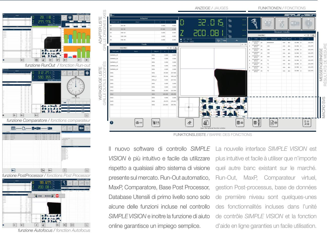
Il nuovo software di controllo SIMPLE VISION è più intuitivo e facile da utilizzare rispetto a qualsiasi altro sistema di visione presente sul mercato. Run-Out automatico, MaxP, Comparatore, Base Post Processor, Database Utensili di primo livello sono solo alcune delle funzioni incluse nel controllo SIMPLE VISION e inoltre la funzione di aiuto online garantisce un impiego semplice.
